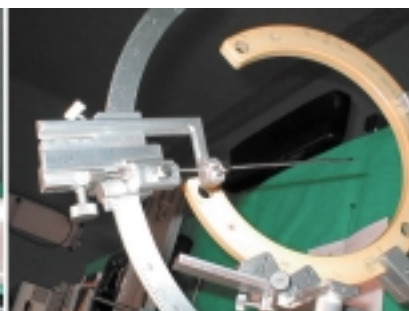
Casco in ceramica con arco, vite micrometrica e sonda, posizionato su phantom.
